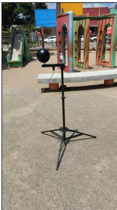
**Figura 04.** Termômetro de globo instalado na Praça da Várzea. **Fonte:** Nóbrega (2016).
