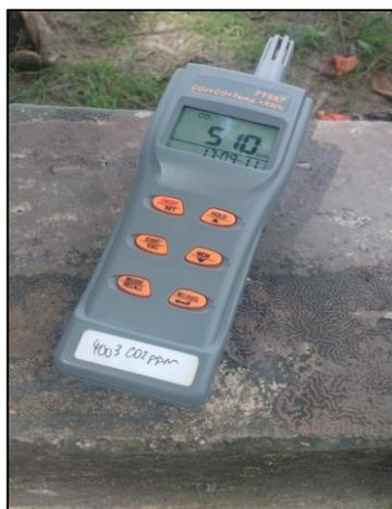
**Figura 04.** Aparelho medidor de CO<sub>2</sub>Highmed (HM – 596) com termohigrômetro embutido utilizado na coleta de dados de temperatura e umidade relativa do ar. **Fonte:** Autores (2018).
