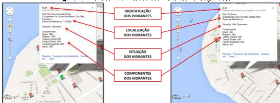
Figura 2: Interface informações dos hidrantes no Google Maps
