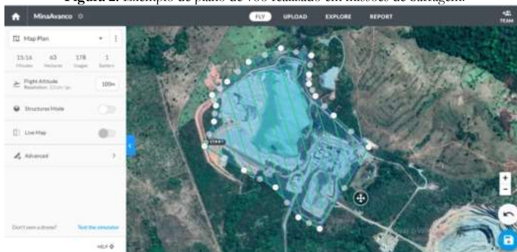
Figura 2. Exemplo de plano de voo realizado em missões de barragem.
