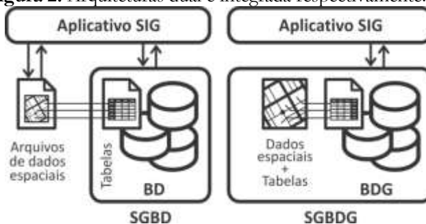
Figura 2: Arquiteturas dual e integrada respectivamente.
