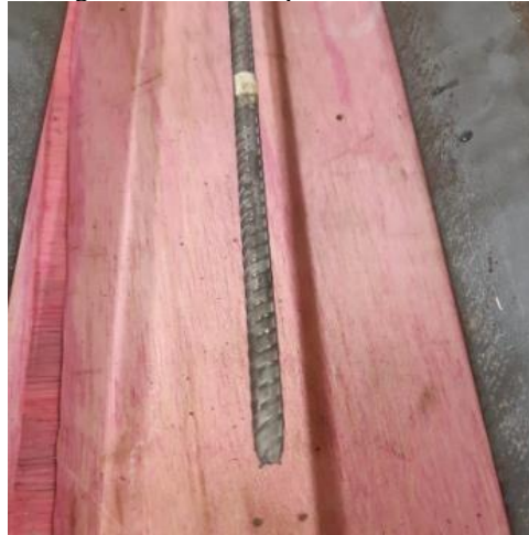
Figura 4: Ensaio de barra de aço CA 50. Figura 5: Barra rompida no ensaio de tração.
