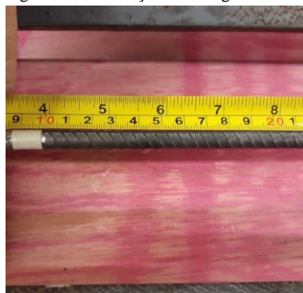
Figura 7: Verificação de alongamento da barra.
