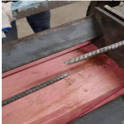
Figura 6: Barra rompida no ensaio de tração.
