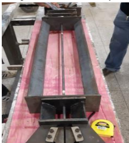
Figura 4: Ensaio de barra de aço CA 50. Figura 5: Barra rompida no ensaio de tração.
