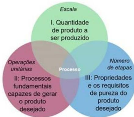
A definição das operações unitárias e da estrutura do processo devem ser realizada com base em informações da literatura e testes experimentais, sendo possível assim, estimar as entradas, as saídas e os rendimentos de cada etapa. É criado, desta forma, um diagrama de fluxo de processo inicial (representação gráfica de todas as operações da unidade, em ordem, conectadas pelos fluxos de materiais apropriados) que pode então ser desenhado no simulador.
