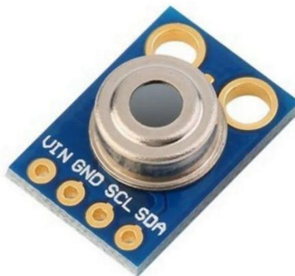
Figura 6.17: Sensor de temperatura infravermelho MLX90614.
