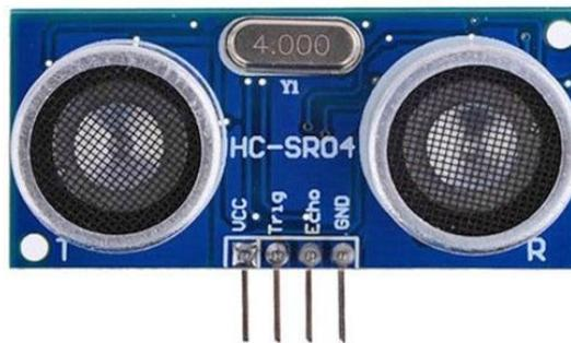
Figura 6.5: Módulo de sensor ultrassônico.
