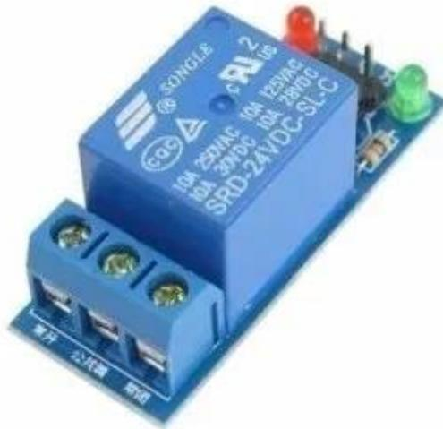
Figura 5.10: Módulo Relé Arduino.
