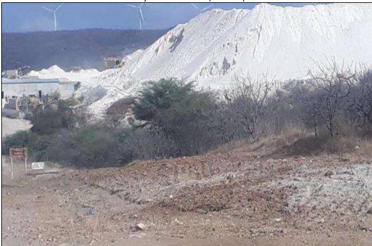
Foto 3- Material de rejeito do caulim depositado pelas mineradoras
