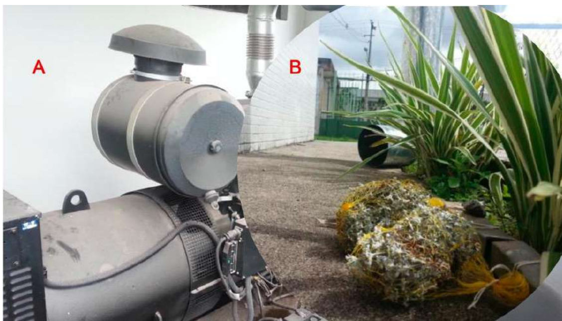
Figura 3 – Cladonia verticillaris exposta ao escapamento de motor estacionário (A), movido ao blend de biodiesel com diesel de petróleo em diferentes distâncias da fonte de poluentes (B).
