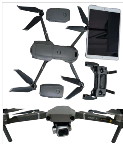
Figura 2 - Sistema de Aeronave Remotamente Pilotada (RPA) e demais dispositivos utilizados para execução dos planos de voo, compostos por: Mavic 2 Pro Kit Fly More e iPad Apple Pro.
