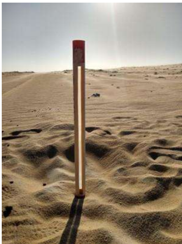
Figura 6 – Armadilha de sedimentos, em Jericoacoara – Ceará.
