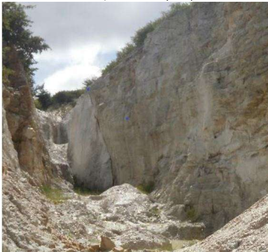
Foto 1- Retirada do capeamento e extração da jazida de caulim
