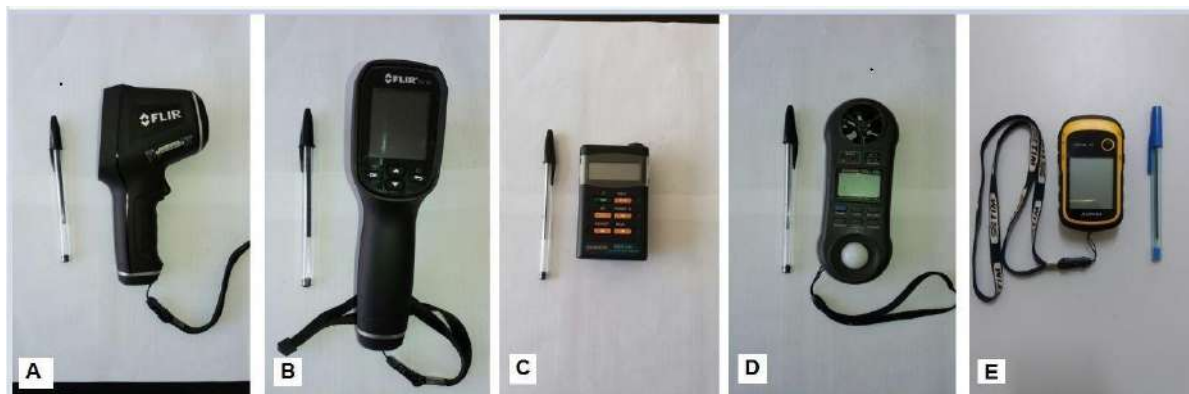
Figura 2. Instrumentos utilizados para a aferição dos dados endofoclimáticos: A e B: Câmera térmica pontual FLIR TG165; C: Medidor de Energia Solar Mod. MES-100 – instrutherm; D: termo-higro-anemometro-luxímetro digital portátil Mod. THAL-300; E: GPS portátil Garmin Mod. etrex 10x, Referente a Análise geoambiental dos afloramentos rochosos na Paraíba.
