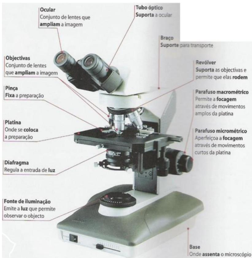
Fig. 02: Microscópio óptico
