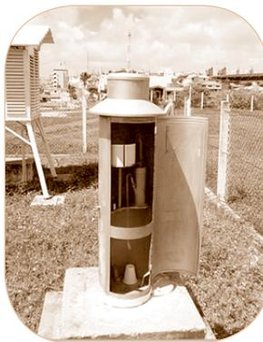
Figura 9 – Pluviógrafo Helmann.
