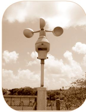
**Figura 6** – Anemômetro totalizador.
