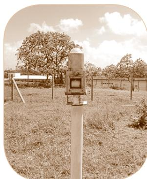
**Figura 3** – Piranógrafo ou actinógrafo bimetalico
