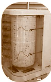
Figura 7 – Termohigrógrafo
