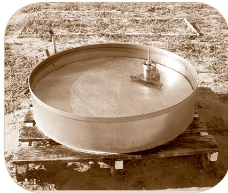
Figura 10 – Tanque de Evaporação Classe A.
