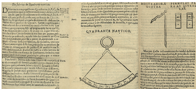
Figura 7: Orientações da fabricação do Quadrante náutico
