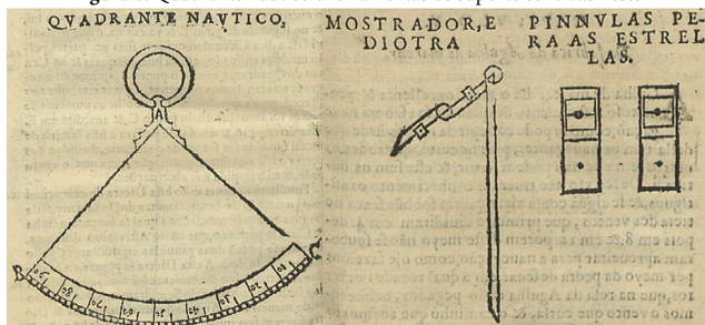
Figura 6: Quadrante náutico e ferramentas de suporte contidas neste
