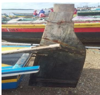
Figura 4: Leme: é instalado na popa da canoa. Tem a função do comando da direção.
