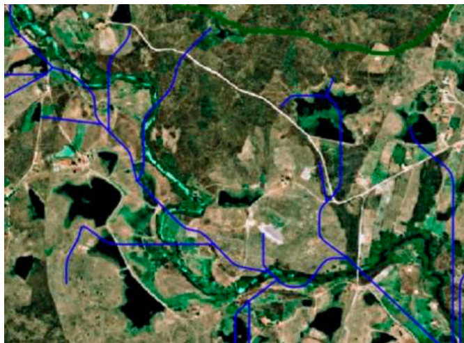
Figura 02 – Drenagem da Serra da Aratanha sobreposta à imagem SPOT. a) Drenagem gerada automaticamente a partir da SRTM; b) Drenagem corrigida com base na imagem SPOT
