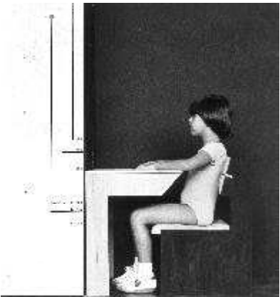
Gráfico esquemático dos testes finais de observação e análise das dimensões CEBRACE. Nas duas fotos superiores a observação do tamanho 2, e nas inferiores uma análise comparativa: na foto à esquerda o aparato foi regulado para as dimensões adequadas, na da direita as alturas de assento e superfície de trabalho estão incorretas, podendo ser observado uma má postura, os pés que mal tocam no chão, falta de apoio lombar , altura excessiva da mesa e pressões sob a coxa.
